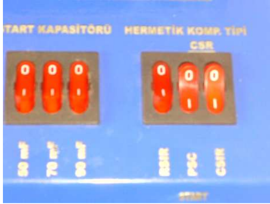
Şekil-9 CSR tipi kompresör için ayarlama
