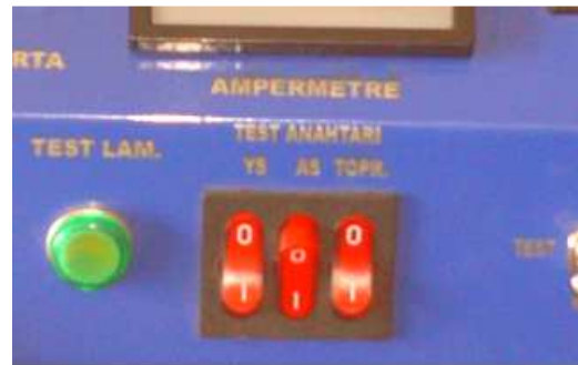
Şekil-5 Ana sargı kopukluğunun testi
