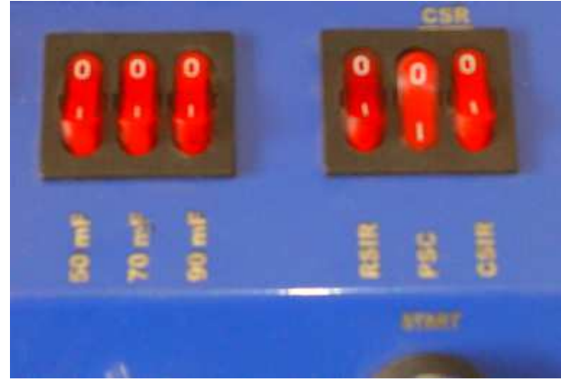
Şekil-10 PSC tipi kompresör için ayarlama
