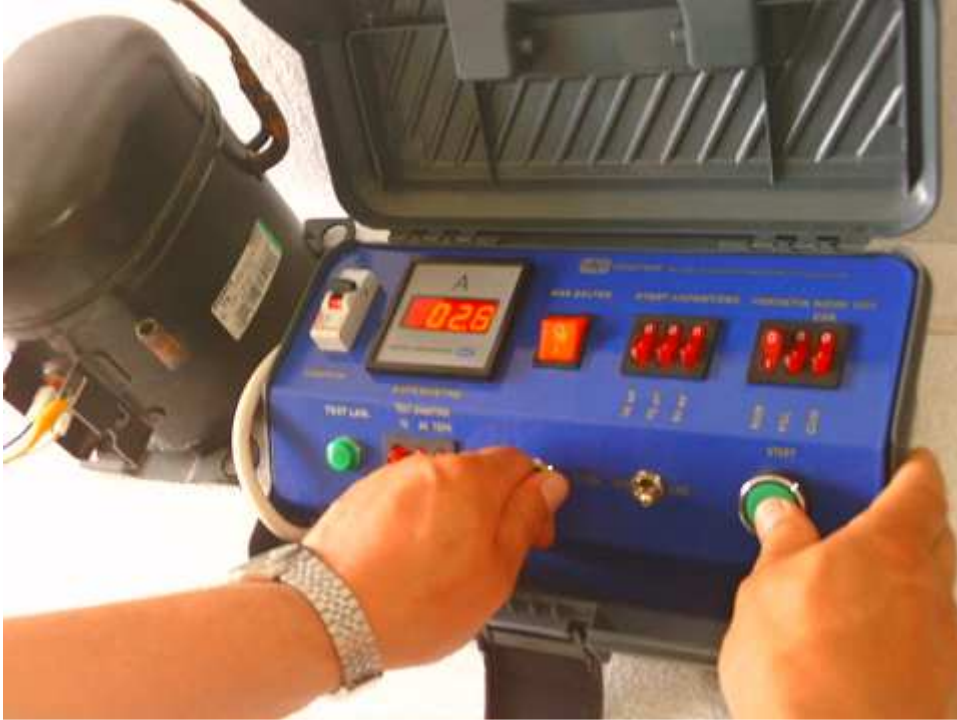
Şekil-11 CSIR kompresörün çalıştırılması
