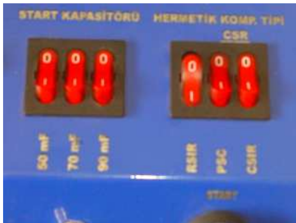
Şekil-7 RSIR tipi kompresör için ayarlama
