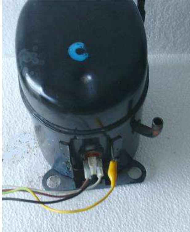
Şekil-2 Kompresör terminal bağlantısı
