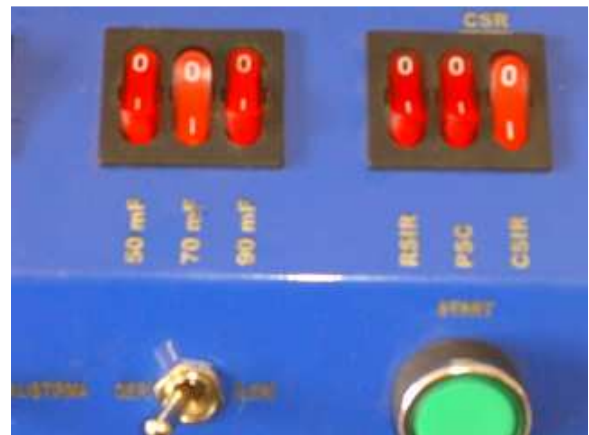
Şekil-8 CSIR tipi kompresör için ayarlama
