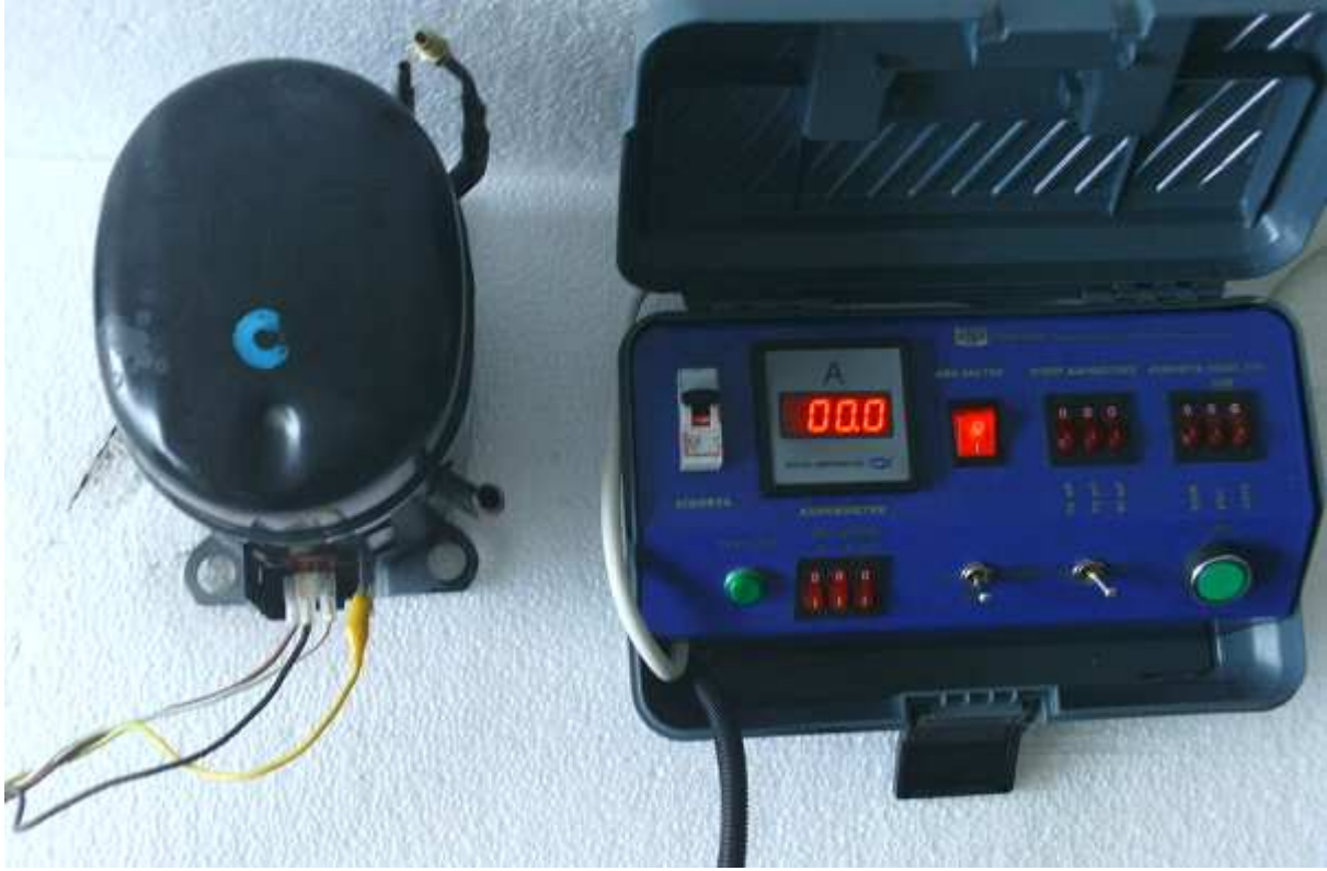
Şekil-3 Cihazın şebekeye ve kompresöre bağlanması
