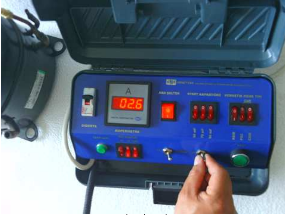
Şekil-12 Sıkışan kompresörün “İLERİ-GERİ” anahtarı yardımıyla açılması
