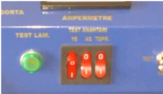
Şekil-4 Yardımcı sargı kopukluğunun testi
