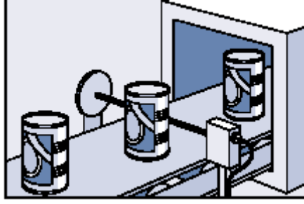
Prizmatik yansıtıcı sensör uygulaması
