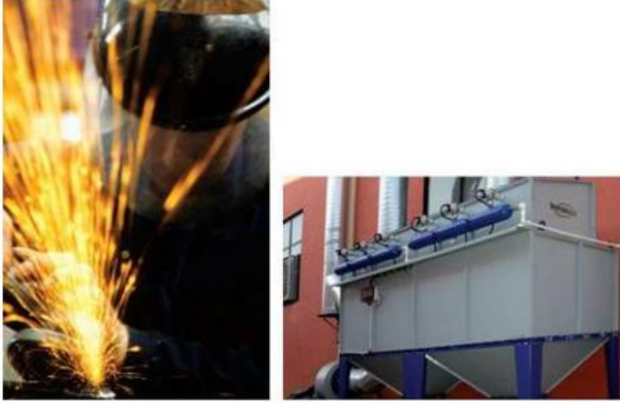
Şekil-9 Patlaçlı kartuş filtre ile taşlama tozlarının emilmesi
