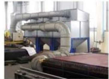
Şekil-18 Plazma ve Lazer kesim esnasında insan sağlığına ve çevreye zararlı yüksek miktarlarda Fe, Fe 2 O 2 ve CrNi tozları meydana çıkar. Endüstrinin ortak sorunu olan işçi sağlığını ve çevreyi tehdit eden bu zararlı toz ve dumanı çalışma ortamından uzaklaştırmak için Patlaçlı Panel Filtre (Jet-Pulse) kullanılır.
