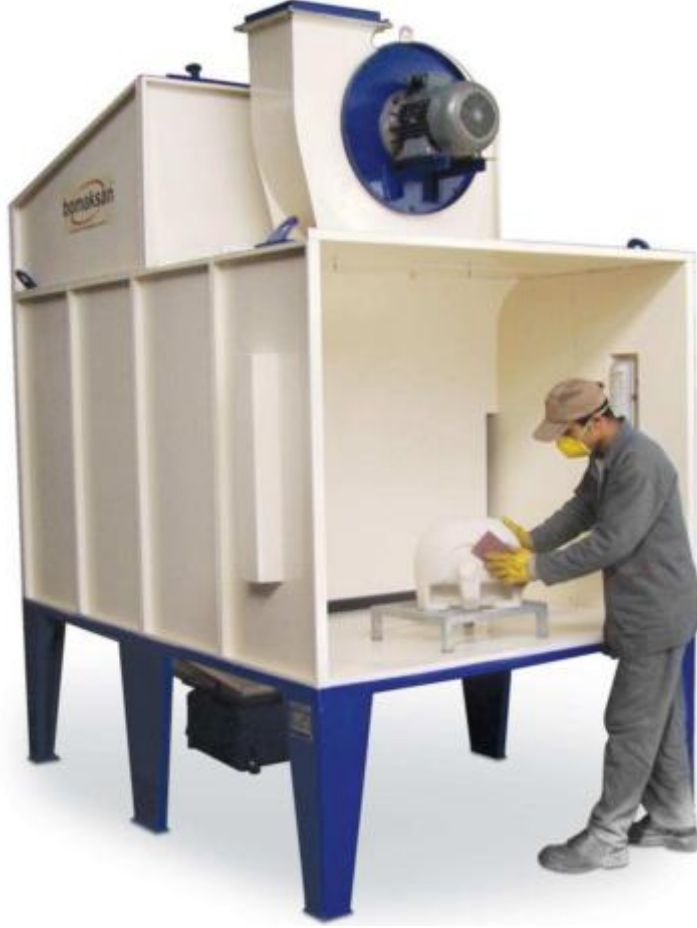
Şekil-19 Seramik zımparalama operasyonu esnasında çıkan toz hem işçi sağlığını hem de ürün kalitesini olumsuz yönde etkiler. Patlaçlı panel (Jet-Pulse) filtreler yardımıyla tamamen tozdan arındırılır.
