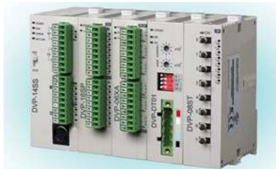
Şekil 4.10 PLC ve ek modülleri
